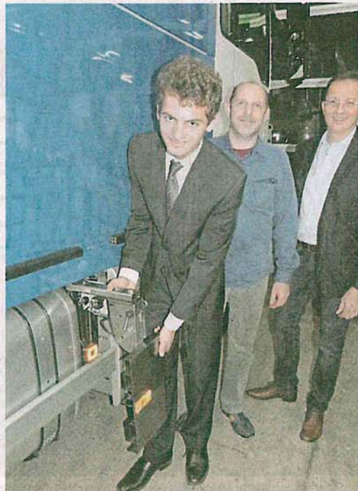
Mit einem klappbaren Seitenanfahrtschutzhalter, der zwischen den Achsen am Fahrzeug angebracht ist, schaffte Stefan Gieger in 14 Stunden den Landessieg des Fahrzeugbauerhandwerks. Der Seitenanfahrtschutzhalter soll verhindern, dass Fahrradfahrer oder Fußgänger beim Abbiegen der Lkw unter die Hinterachse kommen. Unser Bild zeigt (von links) Stefan Gieger, Ausbilder Gernot Vogel und Firmenchef Peter Hofmann. Foto: Werner Reißaus
